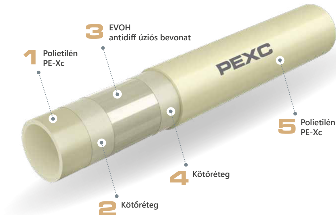
Antidiiffúziós bevonattal ellátott PEXC cső keresztmetszete
