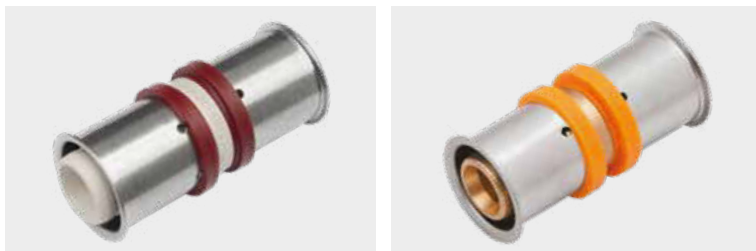
51. Ábra KAN-therm ultraPRESS kapcsolószerkezet 14 × 2, 16 × 2, 20 × 2, 25 × 2,5 mm átmérőjű PERTAL, PEXC, PERT, bluePERT és bluePERTAL csövekhez.
